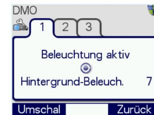
Mit der „+ / - Taste“ wird die Helligkeit eingestellt. Mit der „Umschalttaste“ wird auf „Dunkel“ geschaltet.
