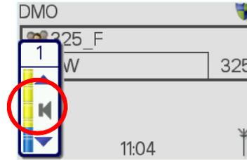
Mit der „+ / - Taste“ und anschließenden Betätigung der „Pfeiltaste nach unten“ wird die Lautstärke im Mannschaftslautsprecher eingestellt.
